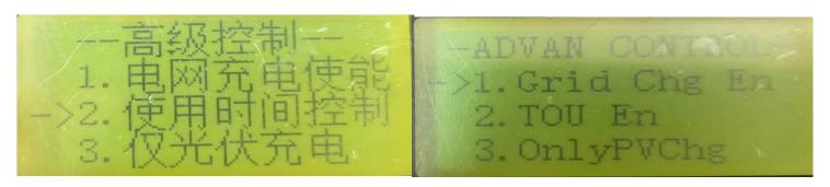
4.1,设置面页:电网充电使能设置--可以电网给电池充电,选择使能(4.3 仅光伏充电必须选择禁止),不可以,选择禁止(4.3 仅光伏充电必须选择允许);
