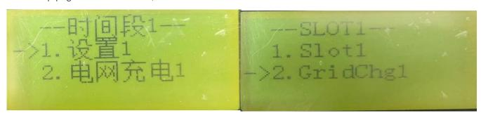
5.1,设置面页:时间段设置--根据充电需求,设置时间段,可以设置6个时间段,根据用电的不同需求,尽量把一整天的时间都设置进去,
