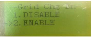
4.2,设置面页:时间控制--按时间段设置给电池充电,选择允许,不按设置时间段充电,选择禁止,启用高级模式,时间段需要设置;
