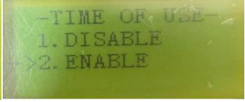
4.3,设置面页:仅光伏充电使能--仅使用光伏充电,选择允许(4.1 电网充电使能必须选择禁止),允许电网参与充电,选择禁止(4.1 电网充电使能必须选择允许);
