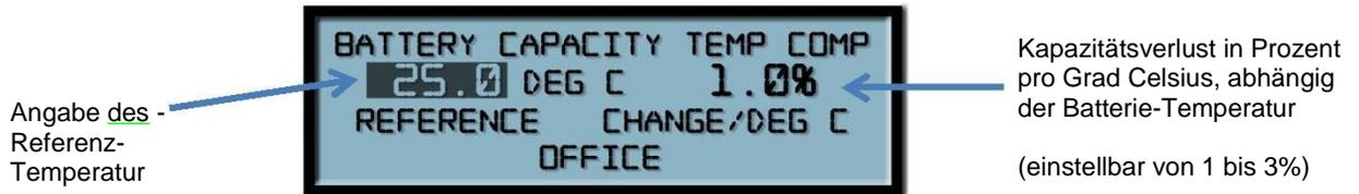
Abbildung 7 – Whizbang jr. "Setup-2" Anzeige
