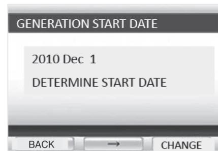
4 Après avoir saisi la GENERATION START DATE (DATE DÉMARRAGE PRODUCTION), sélectionner "DETERMINE START DATE" (ÉTABLIR LA DATE DE DÉMARRAGE) à l'aide de [→] et appuyer sur [ENTER] (ENTRÉE).
