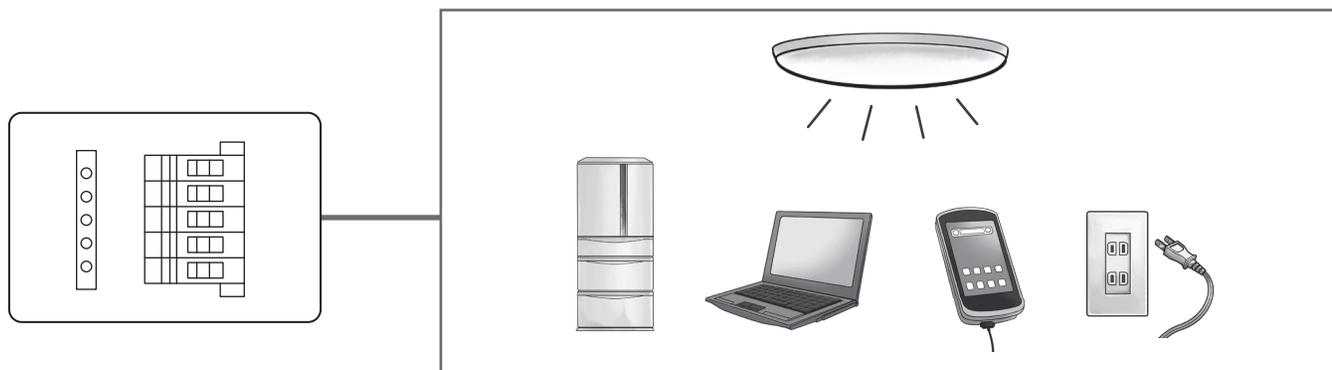
Le montage électrique a été conçu pour permettre l'utilisation des appareils d'éclairage, des équipements de communication et autres appareils électriques en cas de coupure de l'alimentation électrique sans qu'il soit nécessaire de les débrancher et de les brancher de nouveau.
